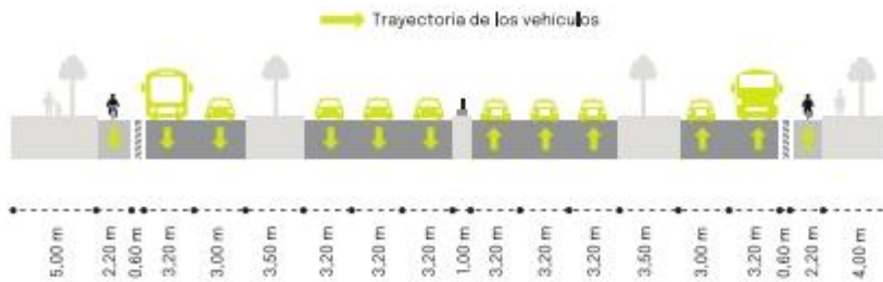
Gráfico 80. Vías de circulación continua a nivel. Fuente: NOM-004-SEDATU-2023, Estructura y diseño para vías urbanas. Especificaciones y aplicación
