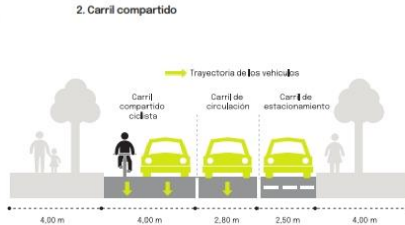
Gráfico 74. Perfil tipo de vía ciclista con prioridad de uso. Carril compartido. Fuente: NOM-004-SE-DATU-2023, Estructura y diseño para vías urbanas. Especificaciones y aplicación.
