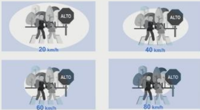
Gráfico 84. Campo de visión por velocidad. Fuente: Control de la velocidad. Manual de seguridad vial decisores y profesionales (2008). Organización Panamericana de la Salud. Elaboración propia.
